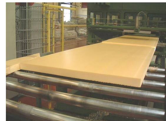
Výroba panelů šíře 1200 mm Plaessa (Tarragona, Španělsko).
